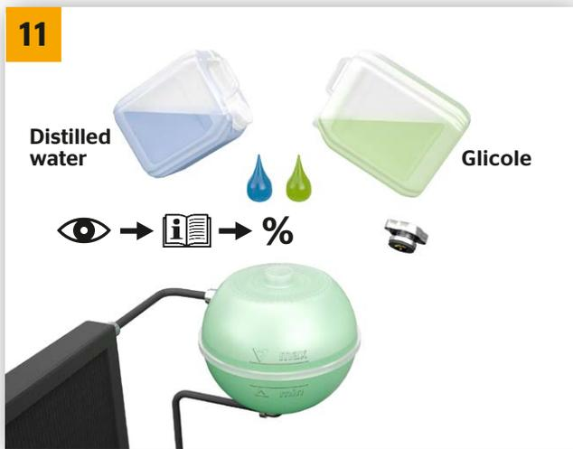
→ Encher o sistema de arrefecimento com líquido de refrigeração novo com a proporção de mistura correta de anticongelante e água. Para o efeito, utilizar exclusivamente o anticongelante concentrado aprovado para o veículo. Conforme o fabricante do veículo e o ano de construção, aplicam-se valores-limite diferentes para a água utilizada (dureza, pH, etc.). Em caso de dúvida, utilize água destilada.
