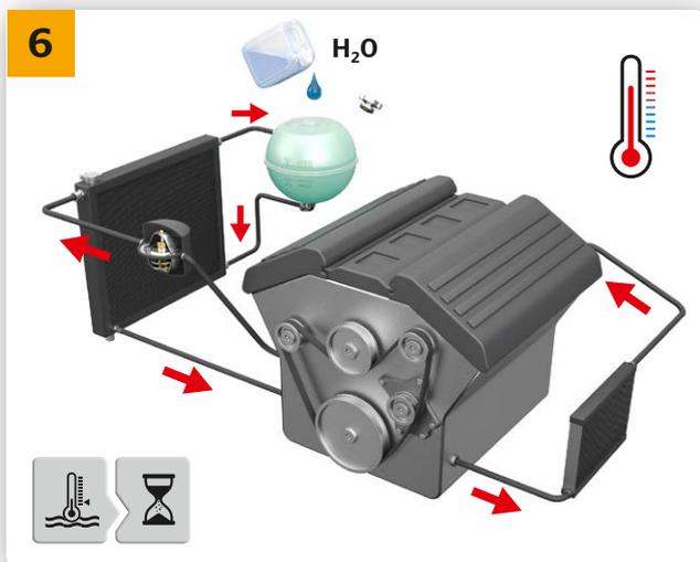
→ Encher o circuito de arrefecimento com água limpa. Deixar o motor funcionar às 2500 rpm até atingir a temperatura de serviço e voltar a drenar a água como descrito nos passos de trabalho 1 e 5.
