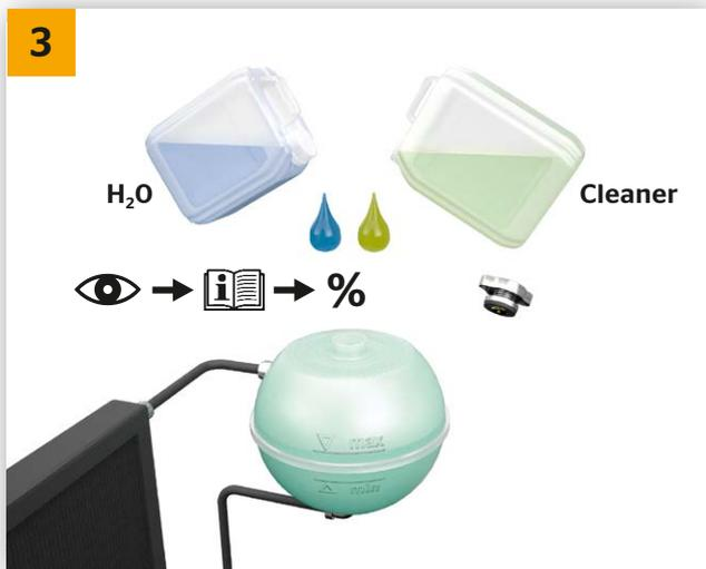
→ Misturar água limpa com aditivo de limpeza (p. ex., MB A0009891025, Liqui Moly 3320, etc.) na proporção de mistura correta e adicionar ao sistema de arrefecimento.
