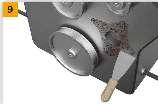
→ Desmontar agora a bomba de água usada e limpar a fundo todas as superfícies de vedação, desengordurando-as também.
