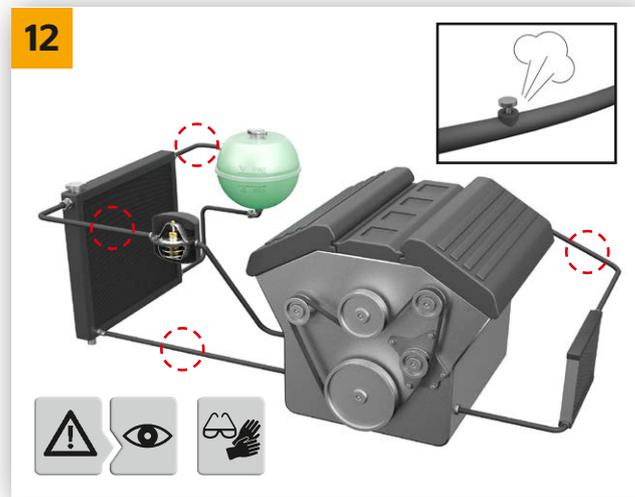
→ Purgar o circuito de arrefecimento de acordo com as indicações do fabricante (se necessário, utilizar aparelho de enchimento) e verificar se existem fugas. Junto á abertura da drenagem da bomba de água, é possível que ocorra uma ligeira e momentânea perda de água, que cessará após um curto espaço de tempo.
